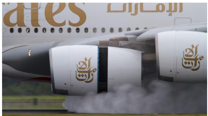
Motor Engine Alliance GP7000 con las reverse door desplazadas. Fuente: aviation.stackexchange.com
